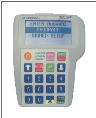
Abbildung 5: Unterschiedliche Pumpen für die kontinuierliche mobile Infusion parenteraler Ernährung. Diese mobilen Infusionspumpen werden entweder mit integriertem Akku oder mit Batterien betrieben. Die dazugehörigen Infusionssysteme sind mit integriertem Fett- und Luftfilter ausgestattet. Für die reine Elektrolytinfusion gibt es diese Systeme auch ohne Filter.
