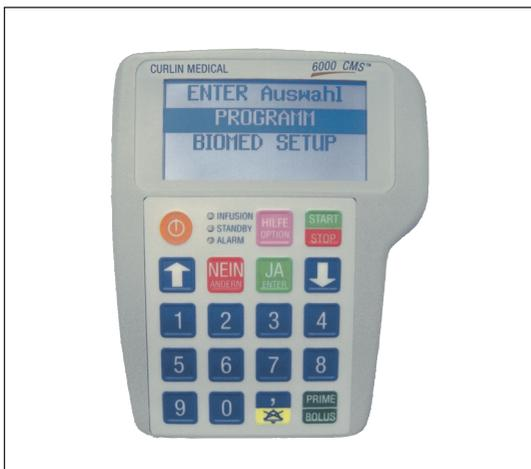
Abbildung 5: Unterschiedliche Pumpen für die kontinuierliche mobile Infusion parenteraler Ernährung. Diese mobilen Infusionspumpen werden entweder mit integriertem Akku oder mit Batterien betrieben. Die dazugehörigen Infusionssysteme sind mit integriertem Fett- und Luftfilter ausgestattet. Für die reine Elektrolytinfusion gibt es diese Systeme auch ohne Filter.
